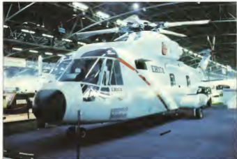
Il mock up (modello a grandezza naturale) dell'EH 101 al Salone Aeronautico di Le Bourget, con i colori della European Helicopter Industries. Si vedono, nel cockpit (torre di pilotaggio), i sedili del pilota e del TACCO con davanti (sotto) il cruscotto che contiene i display grafici sui quali vengono presentati i dati di volo e di missione.
